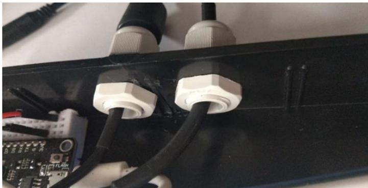
**Figura 20. Desarrollo con prensa-estopa para alimentar la batería interna del dispositivo y permitir su recarga**
